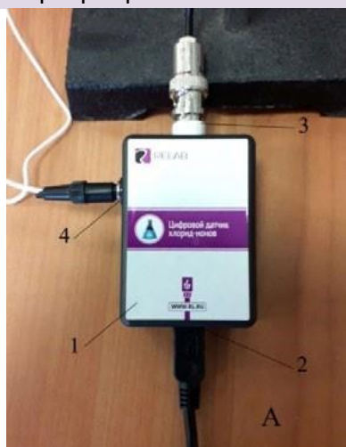
Рис. 3. Установка для определения концентрации (активности) хлорид-ионов в растворе.
