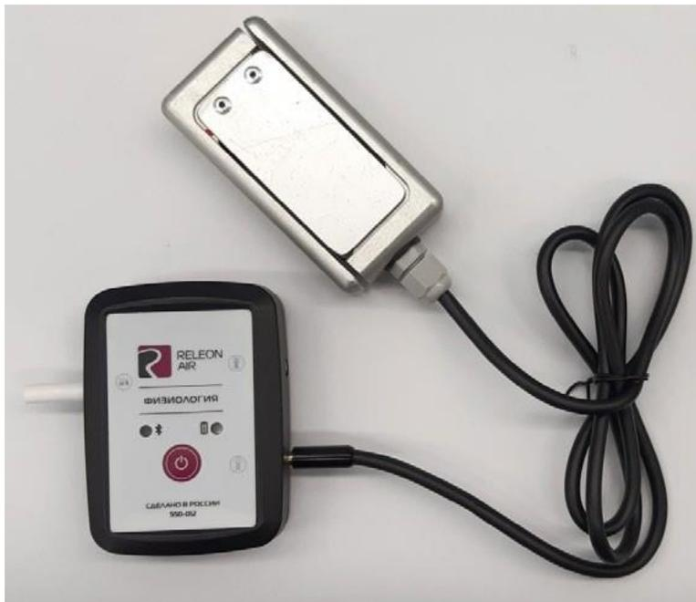
*Рис. 17.* Датчик кистевой силы (эргометр)
