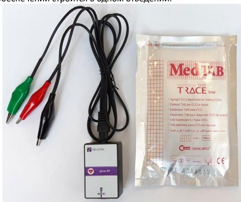
**Рис. 16.** Датчик электрокардиограммы (датчик ЭКГ)
