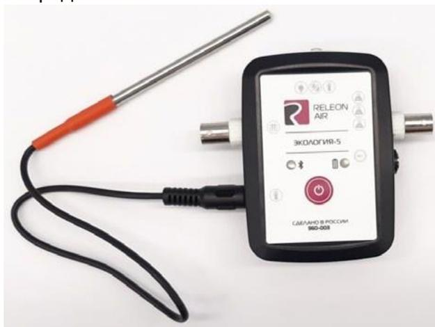
*Рис. 6.* Датчик температуры растворов
