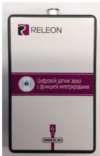
*Рис. 7.* Датчик звука
