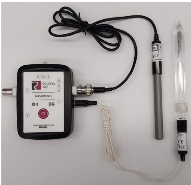
**Рис. 10.** Ионоселективный датчик
