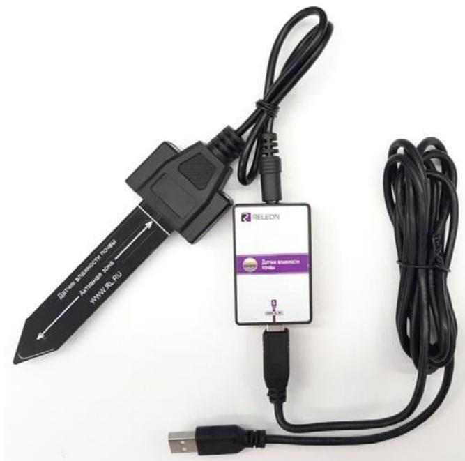
**Рис. 4.** Датчик влажности почвы
