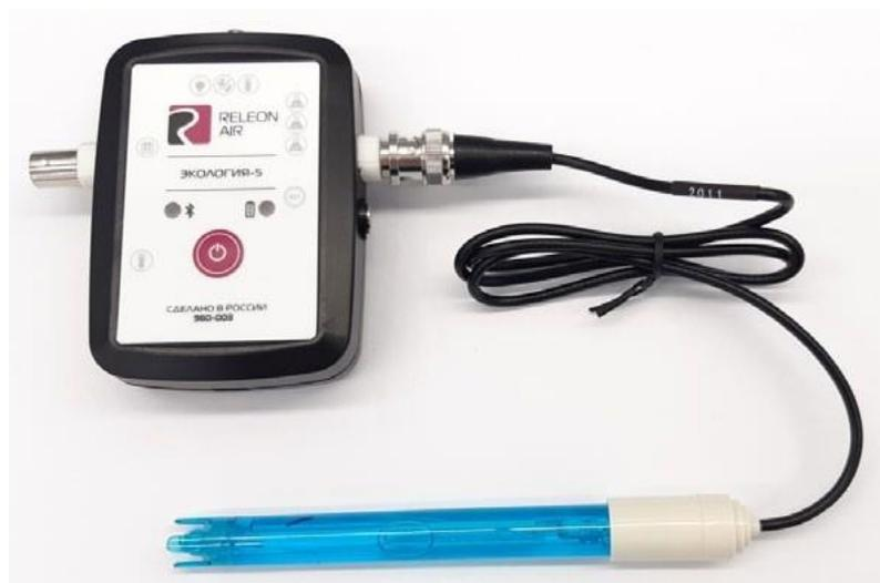
Рис. 9. Датчик водородного показателя (рН)
