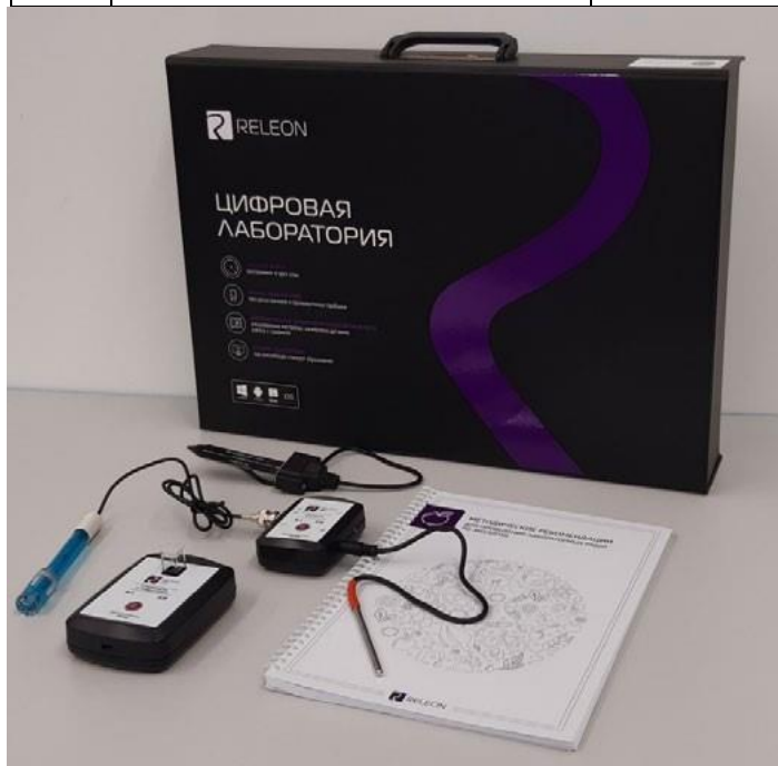
Рис. 2. Мультидатчик по экологии: 1 — освещённость, 2 — относительная влажность воздуха, 3 — температура окружающей среды, 4 — температура растворов, 5 — нитрат-ионы, 6 — хлорид-ионы, 7 — pH, 8 — электропроводность
