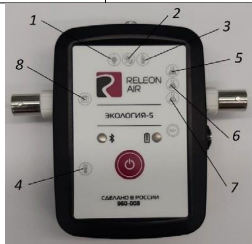
Рис. 2. Мультидатчик по экологии: 1 — освещённость, 2 — относительная влажность воздуха, 3 — температура окружающей среды, 4 — температура растворов, 5 — нитрат-ионы, 6 — хлорид-ионы, 7 — pH, 8 — электропроводность
