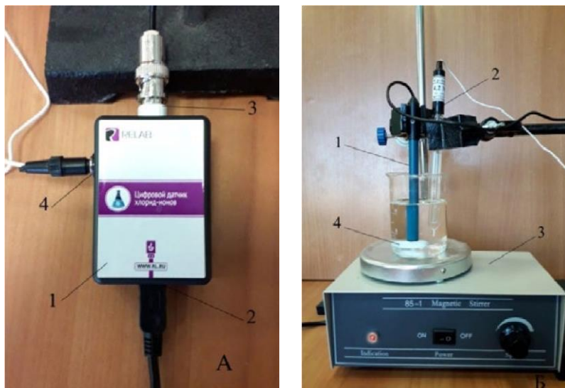
Рис. 2. Установка для определения концентрации (активно-сти) хлорид-ионов в растворе . А: 1 — корпус датчика для определения Cl^- -ионов; 2 — разъём Micro USB для подключения к компьютеру; 3 — разъём BNC для подключения рабочего электрода; 4 — разъём для подключения электрода сравнения . Б: 1 — ионоселективный электрод (рабочий электрод); 2 — электрод сравнения (хлорсеребряный электрод); 3 — нитная мешалка; 4 — якорь магнитной мешалки
