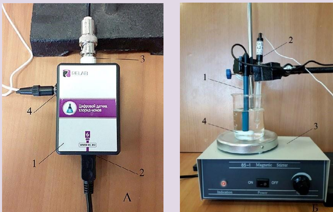
Рис. 3. Установка для определения концентрации (активности) хлорид-ионов в растворе. А: 1 — корпус датчика для определения \text{Cl}^- -ионов; 2 — разъём Micro USB для подключения к компьютеру; 3 — разъём BNC для подключения рабочего электрода; 4 — разъём для подключения электрода сравнения. Б: 1 — ионоселективный электрод (рабочий электрод); 2 — электрод сравнения (хлорсеребряный электрод); 3 — магнитная мешалка; 4 — якорь магнитной мешалки
