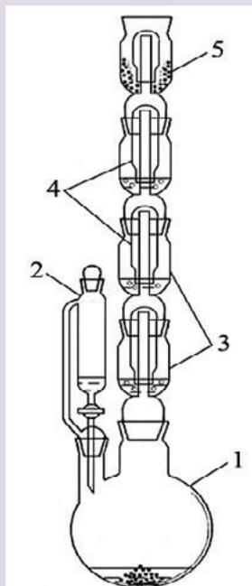
**Рис. 4.** Аппарат для проведения химических реакций (АПХР): 1 — двугорлая колба-реактор; 2 — делительная воронка для работы с токсичными веществами, позволяет добавлять необходимое количество жидкого реагента в реакционную смесь, не допуская разгерметизации прибора; 3 — ёмкости (насадки) для жидких реагентов (поглотителей); 4 — колпаки; 5 — ёмкость (насадка) для сыпучих реагентов
