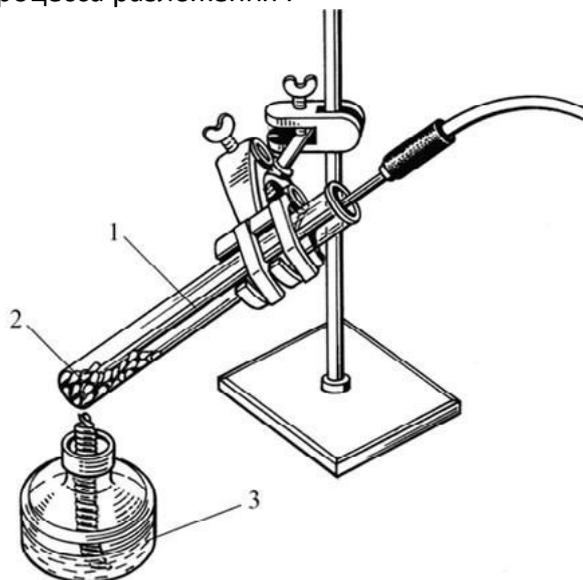
**Рис. 9.** Прибор для определения температуры плавления:
