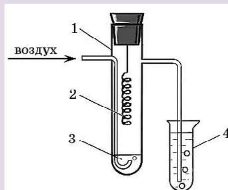
**Рис. 6.** Прибор для окисления спирта над медным катализатором: 1 — пробирка со встроенной трубкой и боковым отводом; 2 — спираль из медной проволоки, закреплена в резиновой пробке; 3 — спирт; 4 — пробирка-приёмник
