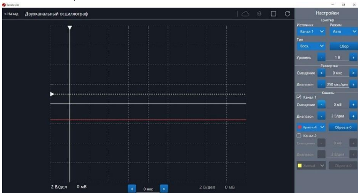
Рис. 40. Сигнал с ненулевым смещением
