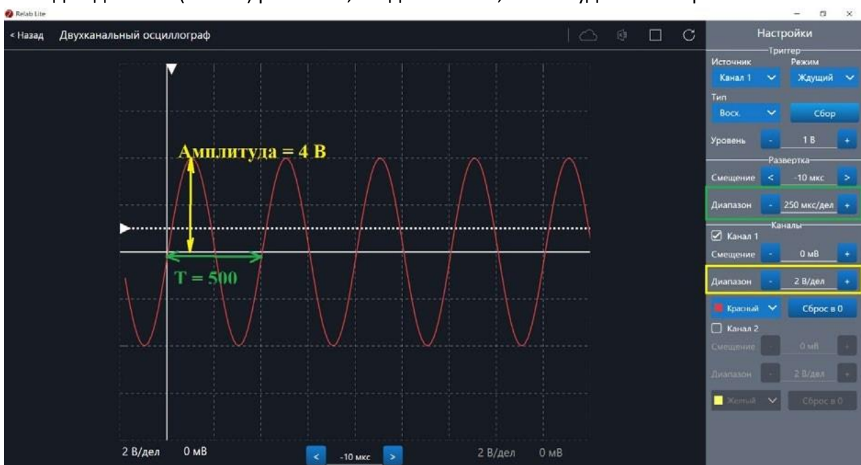
Рис. 42. Определение параметров осциллограммы
