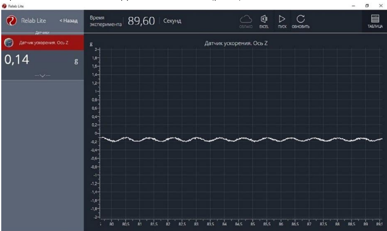
Рис. 3. График гармонических колебаний пружинного маятника
