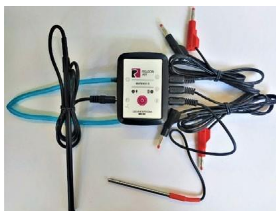
Рис. 9. Беспроводной мультидатчик Releon Air «Физика-5»
