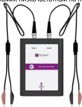
Рис. 1. Двухканальная приставка-осциллограф на подставке
