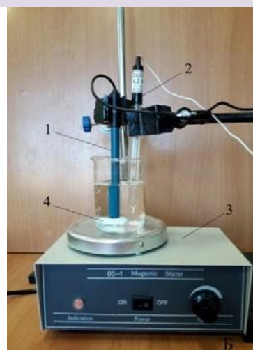
Рис. 3. Установка для определения концентрации (активности) хлорид-ионов в растворе.
