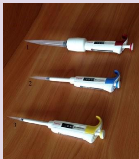
Рис. 7. Пипетки-дозаторы одноканальные переменного объёма: 1 — 1—10 мл; 2 — 100—1000 мкл; 3 — 10—100 мкл.
