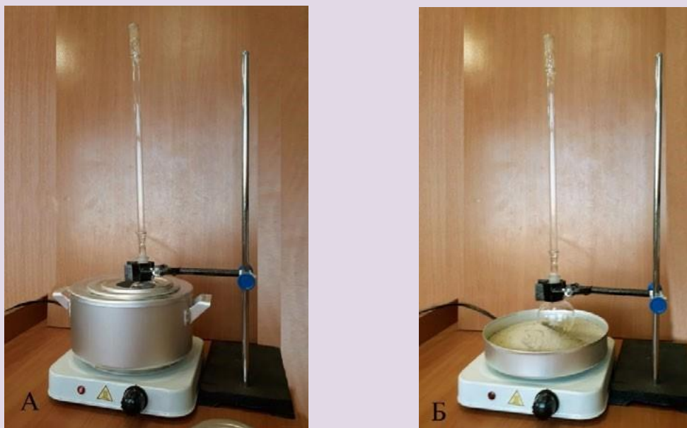
Рис. 8. Баня комбинированная лабораторная . А — водяная баня . Б — песчаная баня
