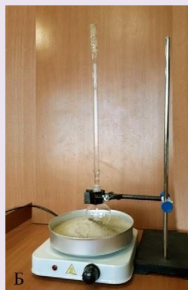
Рис. 6. Баня комбинированная лабораторная. А — водяная баня. Б — песчаная баня
